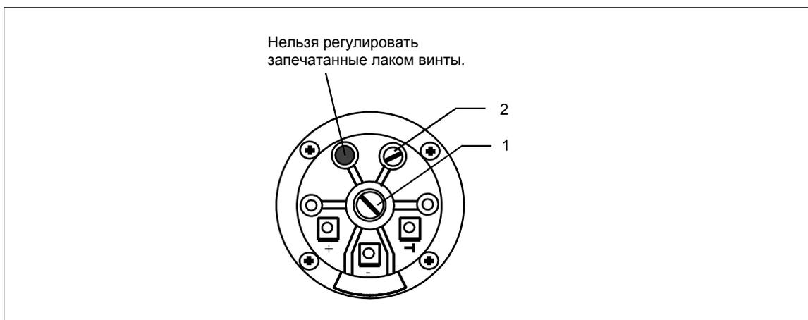
Рис. 6-6 Винты для настройки переключателя давления.
