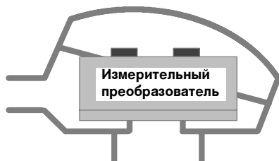
Рис. 4 Крепление измерительного преобразователя SITRANS TK/TK-H в нижней части соединительной головки
