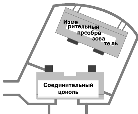
Рис. 3 Крепление измерительного преобразователя SITRANS TK/TK-H в крышке соединительной головки
