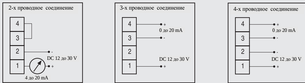
Рис 3/89 Сельсин-измерительный преобразователь SITRANS FVA 252, схемы соединения
