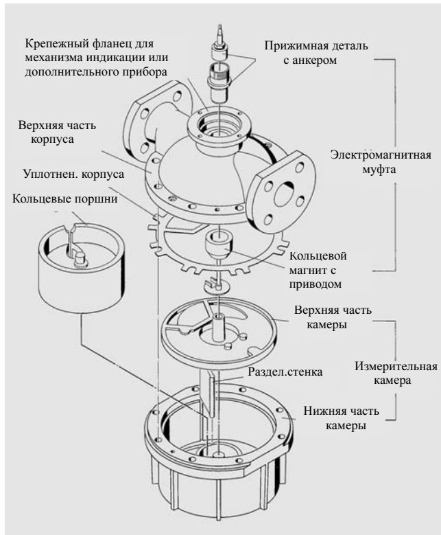
Рис. 3/144 Измерительный механизм кольцевого счетчика DN 25/PN 10 (1"/MWP 145 psi) (промышленная конструкция)
