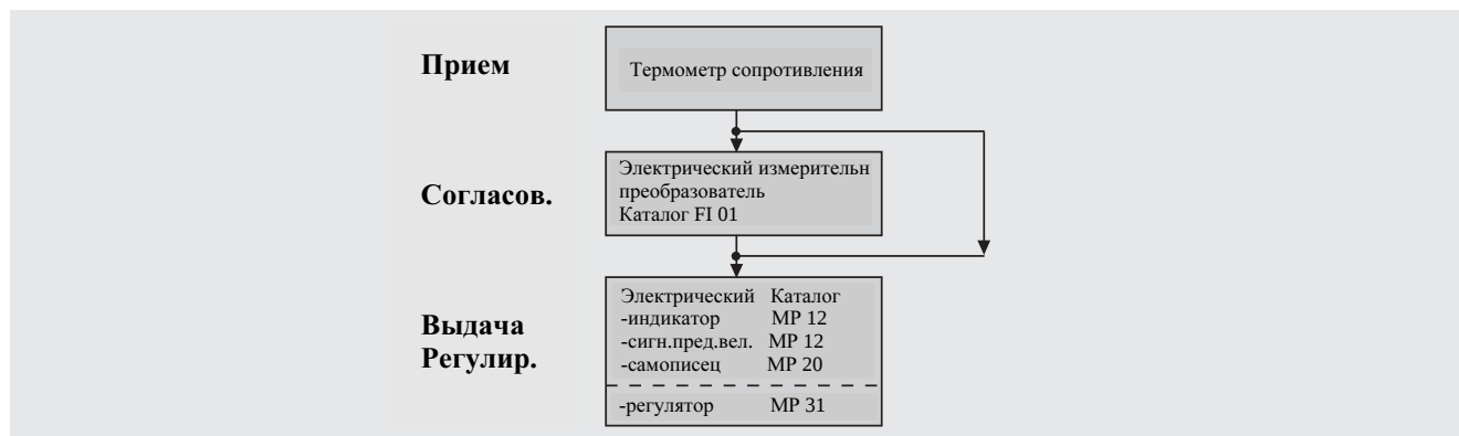
Рис 2/44 Комбинация приборов для измерения и регулирования температуры, с термометром сопротивления в качестве чувствительного элемента
