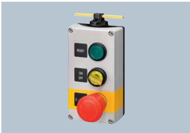
Благодаря корпусам с AS-интерфейсом периферийные аппараты управления типоряда 3SB3 можно быстро ввести в систему автоматизации. С помощью предлагаемых компонентов можно самостоятельно собрать пульт со встроенным AS-интерфейсом или гибко модернизировать имеющийся пульт.
