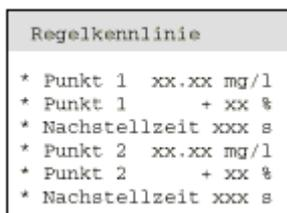
Здесь Вы можете установить критические точки для обеих цепей регулятора для согласования характеристики регулирования и соответствующего времени издрорма.
