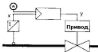
Регулируемая величина  $x$  подается на аналоговый вход AE1 регулятора; питание измерительного преобразователя осуществляется через те же линии. Размах входного сигнала и выдаваемое управляющее воздействие регулятора составляют 4 до 20 мА.
