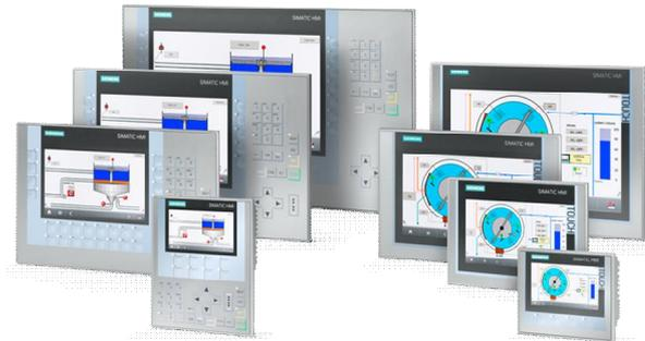
В панелях операторов с мембранной клавиатурой все программируемые функциональные клавиши оснащены встроенными светодиодами. Системные клавиши таких панелей подобны клавиатуре мобильного телефона.
