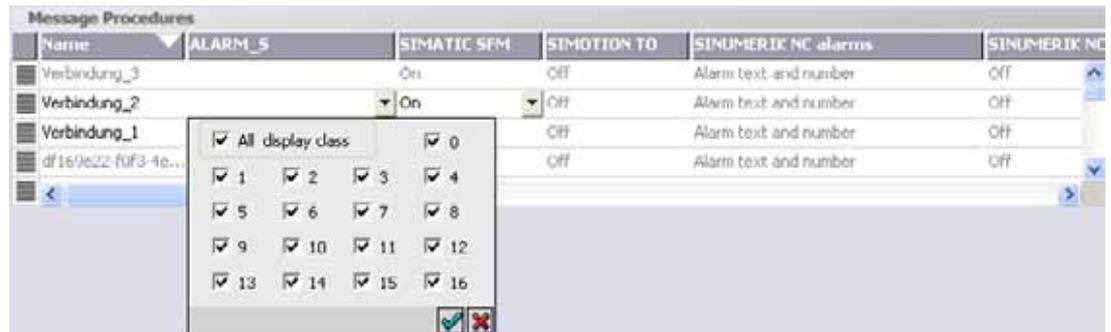
В строке требуемого соединения выделите поле в столбце "ALARM\_S Display Classes [Классы отображения ALARM\_S]" и откройте диалоговое окно выбора, нажав кнопку выбора. Выберите требуемый класс отображения. Закройте диалоговое окно, нажав кнопку
