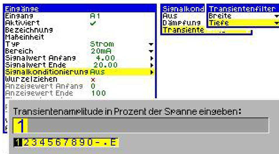
Настроить опцию **фильтр переходных процессов (Transienten filter)** таким образом, чтобы определенный вид импульсов не учитывался. **Ширина (Breite)** отклоняемого импульса может быть установлена между 1 и 15 секундами. **Глубина (Tiefe)** импульса задается как процент интервала. Интервал определяется через шкалу единиц измерения, к примеру, начальное значение индикации = -10, конечное значение индикации = +10. Ввести глубину пика импульса как процент интервала = 20.
