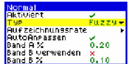
**Автоматическое согласование (AutoAnpassen)** обеспечивает запись последнего измеренного значения элементов данных до выхода сигнала из нижней зоны А или зоны В установленного диапазона допуска. При графическом представлении изображение входного сигнала автоматически подстраивается под эту последнюю измеряемую величину.
