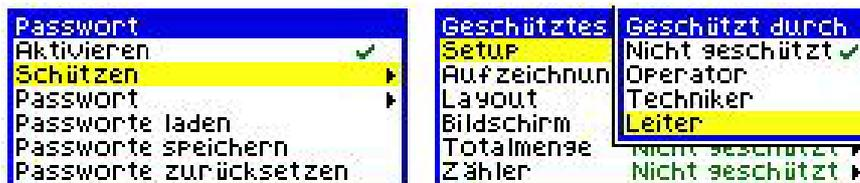
Выбрать каждую из шести областей, **Setup**, **Запись (Aufzeichnung)**, **слой (Layout)**, **экран (Bildschirm)**, **общее количество (Totalmenge)** и **счетчик (Zähler)**. Определить, каким уровнем пользователя должна быть защищена каждая область, или области не должны быть защищены и быть доступны для всех.
