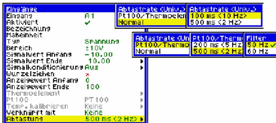
Обычный опрос относится к скорости, с которой работает модуль при использовании входов напряжения или тока. Для входов терморпар и термометров сопротивления частотой опроса является скорость, с которой работает модуль, когда один или несколько входов установлены на сигналы терморпары или термометра сопротивления
