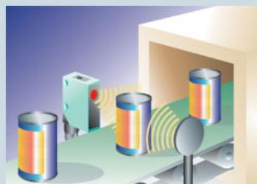
*Счет с помощью фотореле с отражателем*
