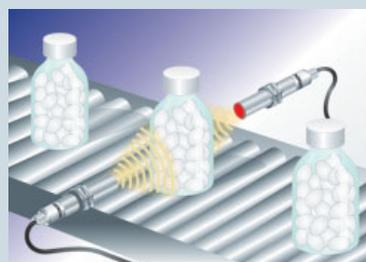
*Счет с помощью фотодатчика барьерного типа*
