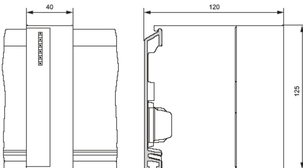
Рис. С-15. Интерфейсный модуль IM 360
