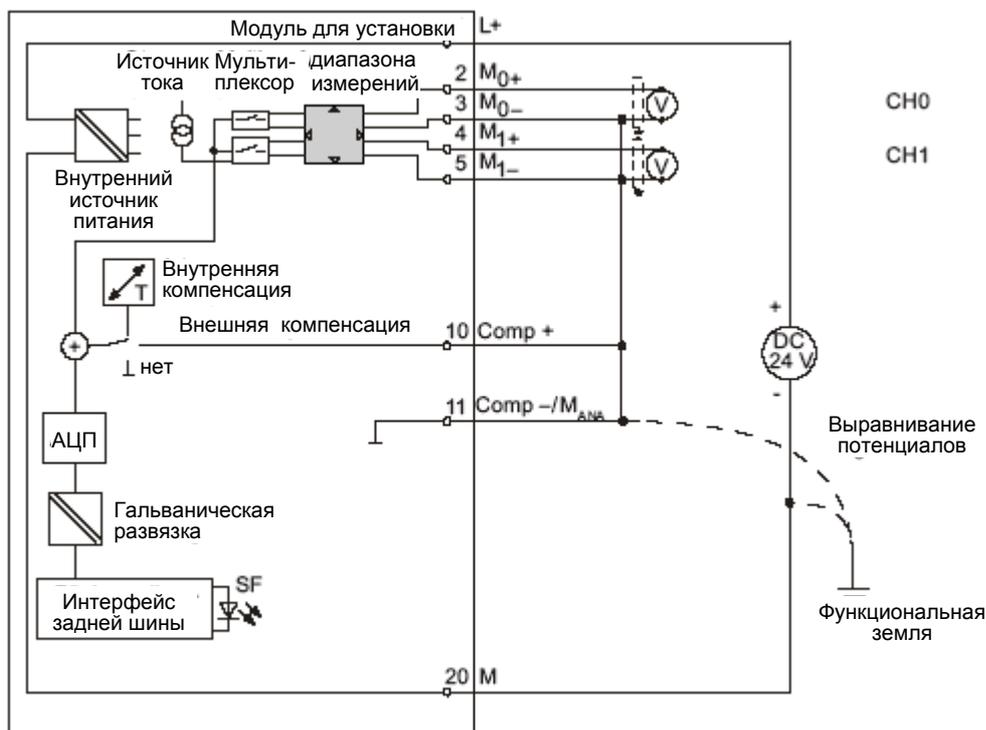
Рис. 6-18. Схема подключения и принципиальная схема
