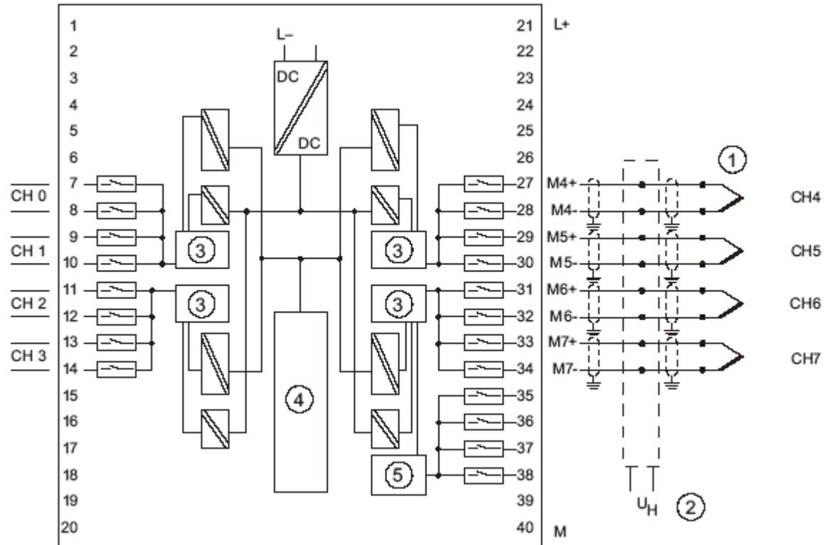
Рис. 6-26. Схема подключения и принципиальная схема
