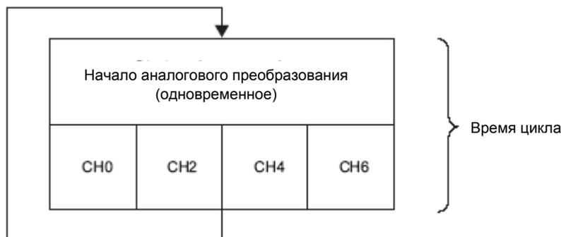
Рис. 6-31. Время цикла для 4-канального режима (аппаратный фильтр)
