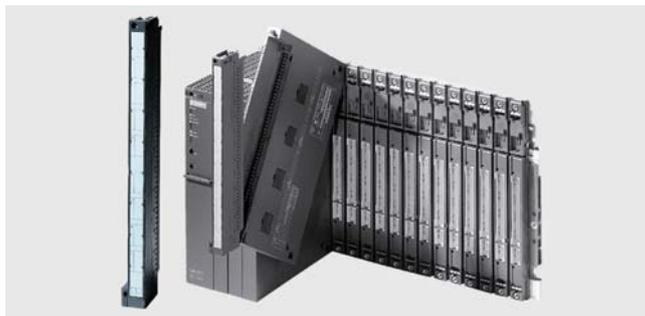
Внешние цепи большинства модулей программируемых контроллеров S7-400 подключаются через съемные фронтальные соединители. Фронтальный соединитель устанавливается на специальный разъем модуля и закрывается защитной пластиковой дверцей. Такая конструкция упрощает выполнение операций подключения внешних цепей и позволяет производить замену модулей без демонтажа всех внешних соединений. В паз защитной дверцы устанавливается этикетка, на которой наносится маркировка внешних цепей.
