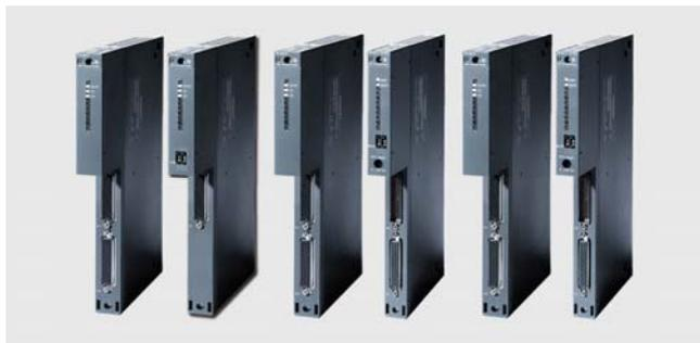
Интерфейсные модули предназначены для построения систем локального ввода-вывода программируемых контроллеров S7-400/ S7-400F/ S7-400FH/ S7-400H и организации связи между базовым блоком и стойками расширения.
