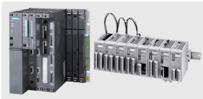
Внешние цепи каналов ввода-вывода дискретных и аналоговых сигналов подключаются к модулям FM 458-1 DP и EXM 438-1 через соединительные кабели и интерфейсные модули соответствующих типов. Интерфейсные модули оснащены терминальными блоками для подключения внешних цепей и имеют светодиодную индикацию. Некоторые типы интерфейсных модулей обеспечивают преобразование уровней сигналов и гальваническое разделение цепей.
