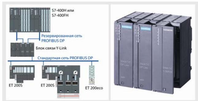
Блок связи Y-Link выполняет функции согласующего устройства между резервированной и стандартной сетью PROFIBUS DP. С его помощью к ведущему DP устройству резервированной сети PROFIBUS DP (например, к программируемому контроллеру S7-400H) могут подключаться стандартные ведомые DP устройства. В резервированной сети PROFIBUS DP блок связи Y-Link выполняет функции ведомого, в стандартной сети PROFIBUS функции ведущего DP устройства.
