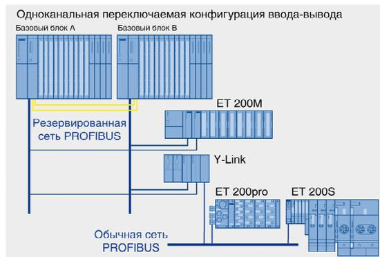
4. Симметричной установкой двух одинаковых модулей в две станции ET 200M одноканальной системы распределенного ввода-вывода одного базового блока S7-400H. Рекомендуется в случаях поэтапного внедрения H-системы (на первом этапе устанавливается один, на втором этапе – второй базовый блок программируемого контроллера S7-400H).
