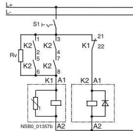
Rv: В контакторах 3ТВ54, 3ТВ56 и 3ТС56 последовательно включены 2 резистора.
