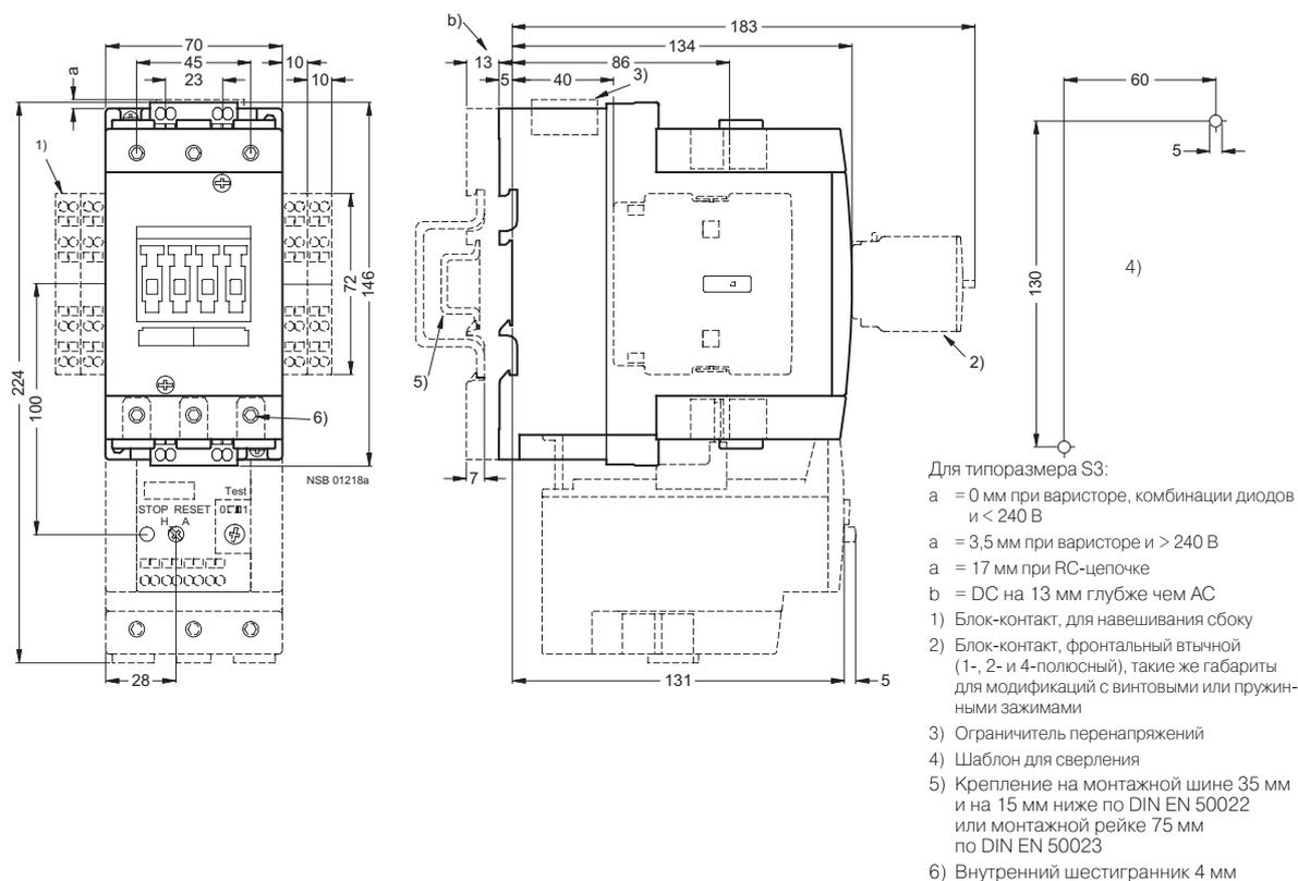
Согласующие контакторы 3RT10, типоразмер S00
