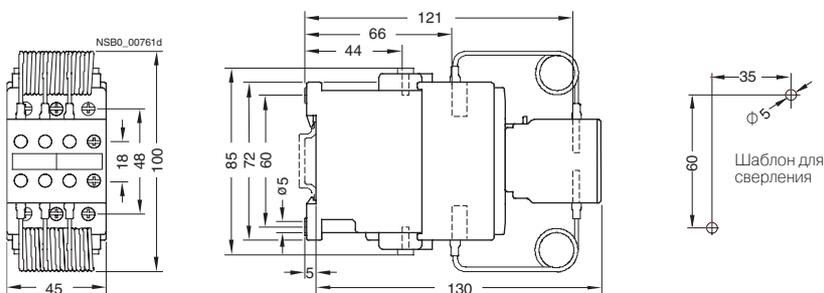
Контакторы для коммутации конденсаторов 3RT16 47, типоразмер S3
