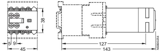
Электронные блоки реле времени, с задержкой притягивания
