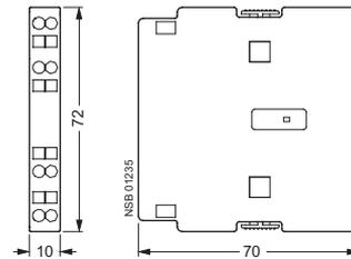
1) Внешние габариты при винтовых и пружинных зажимах идентичны.
