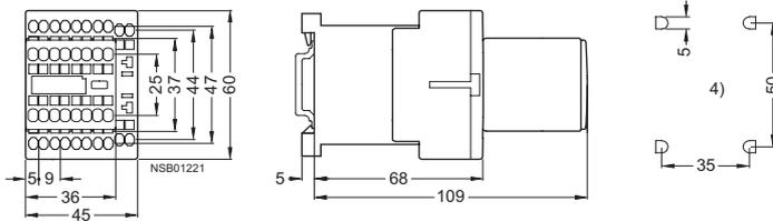
Контакторы 3RT10 2, контакторы связи 3RT10 2, типоразмер S0
