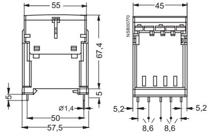
Устройство задержки отключения
