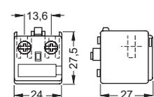
1) Отклонения в размерах для блок-контактов с пружинным зажимом: монтажная глубина 42 мм.
