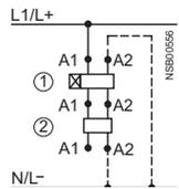
A2 может подключаться к N (L-) либо на контакторе, либо на реле времени.
