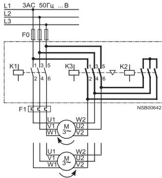
Цепи управления с блок-контактом с электронной выдержкой времени 3RT19 16-2G..., фронтальным на защелке (предлагаемые схемы)
