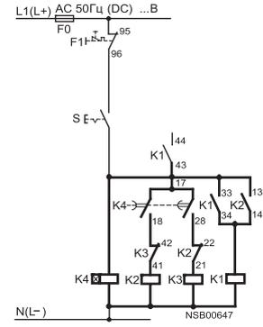
Контакт-деталь 17/18 замкнута только в схеме звезды; в схеме треугольника и в обесточенном состоянии контакт-деталь разомкнута.
