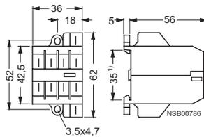
Контакторы 3TG10 с реле перегрузки 3UA7
