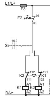
Механическая блокировка 3RA19 24-2B содержит НЗ-контакт на каждый контактор для блокировки размыкания.
