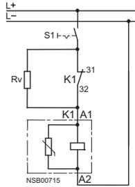
Схема с предвключенным резистором Rv и реверсивным контактором K2 (для контакторов K1, начиная с типоразмера 8)
