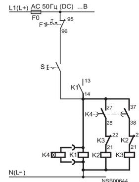
Контакт 27/28 блок-контакта с электронной выдержкой времени и функцией звезда-треугольник замкнут только в схеме звезды; в схеме треугольника и в обесточенном состоянии контакт разомкнут
