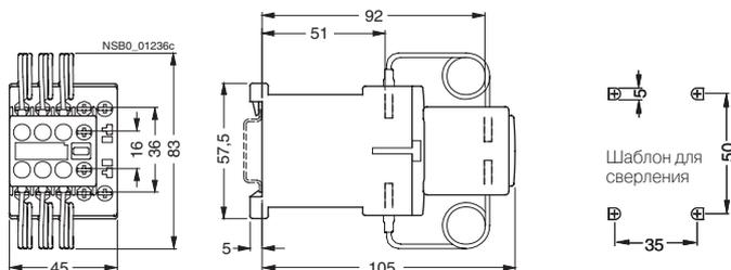
Контакторы для коммутации конденсаторов 3RT16 27, типоразмер S0
