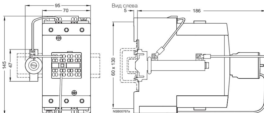
1) Контакторы S0 до S3: Электромонтаж предвключенного резистора контактора должен выполняться заказчиком. Предвключенный резистор снабжен необходимыми соединительными проводами.
