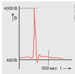
Емкостная развязка с различными аналоговыми и цифровыми сигналами приводит к необходимости помехоподавления в силовой цепи.
