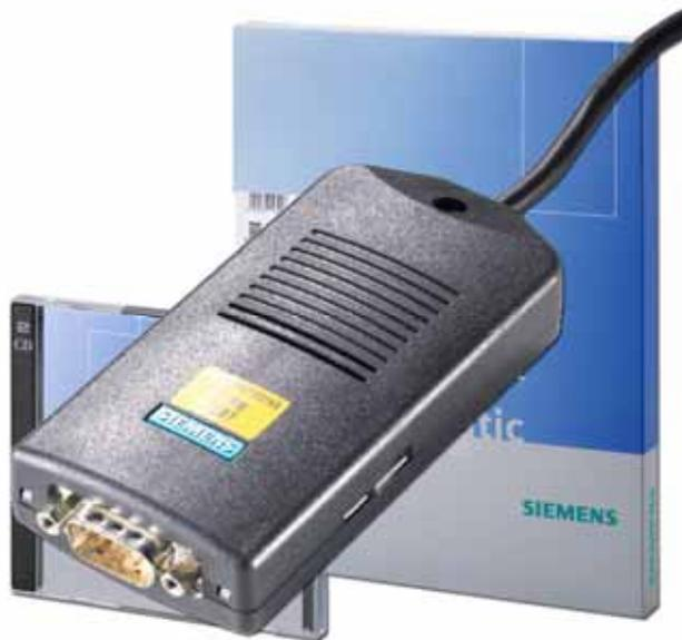
STEP 7 может быть установлен на офисный компьютер или ноутбук, оснащенный только стандартным набором компьютерных интерфейсов. В этом случае для подключения компьютера к программируемому контроллеру SIMATIC S7/C7 может использоваться один из указанных ниже адаптеров.
