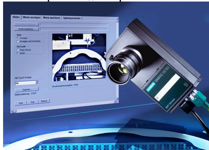
VS 720 – универсальная система анализа видео изображений, включающая в свой состав видео камеру и блок обработки изображений с классом защиты IP 61. Система оснащена встроенным интерфейсом Ethernet для цифровой передачи видео изображений и быстрого конфигурирования, а также интерфейсом ведомого устройства PROFIBUS-DP.
