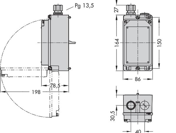
Монтаж согласно DIN IEC 534 и NAMUR
