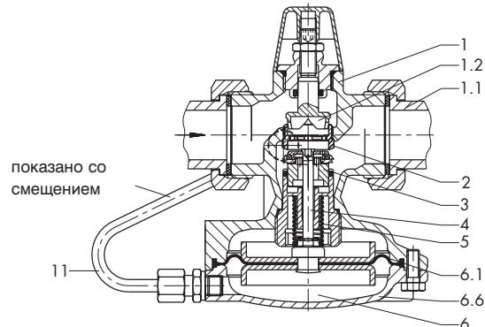
Рис. 3 · Регулятор объемного расхода тип 45-9, вид в разрезе Py 25
