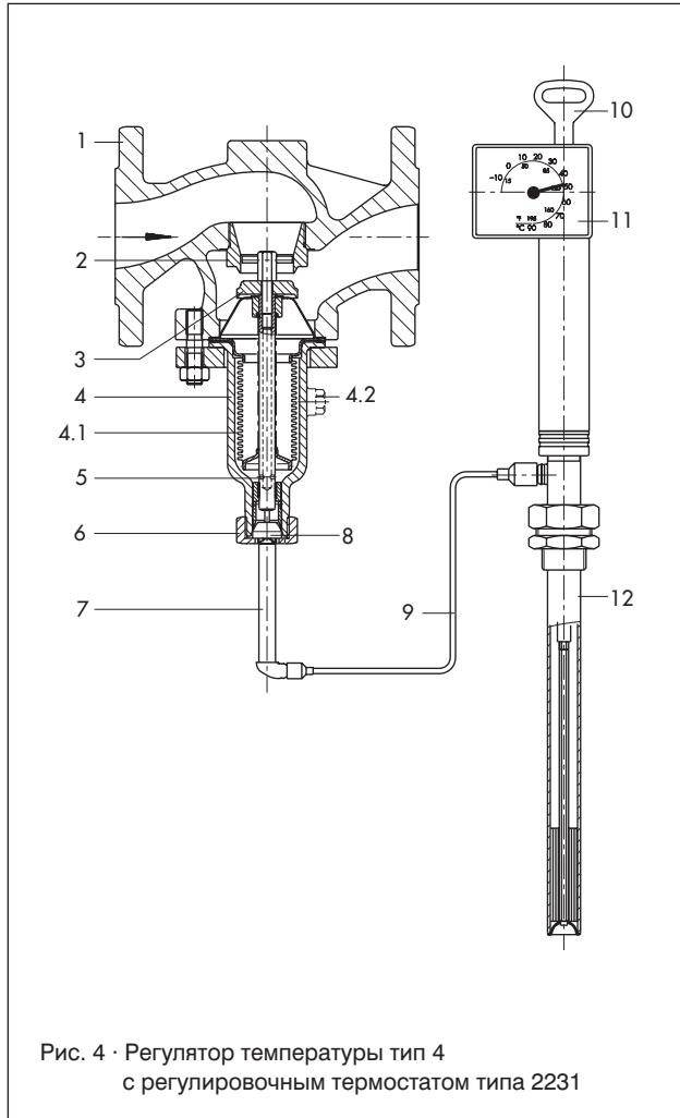
Рис. 4 · Регулятор температуры тип 4
