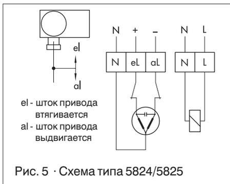
У типа 5825 предохранительный магнит находится под постоянным напряжением. Если на **eL** дать напряжение, двигатель втягивает шток привода внутрь (шток привода втягивается).
