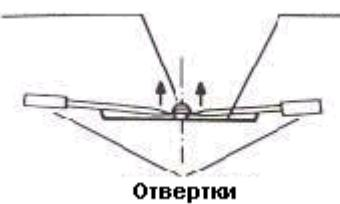
2. Удалите указатель, используя специальный экстрактор, либо поддав его снизу с помощью двух отверток.
