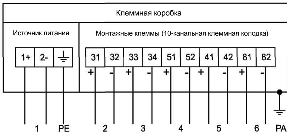
Рис. 3.8: Y клемм при использовании во взрывобезопасной зоне
