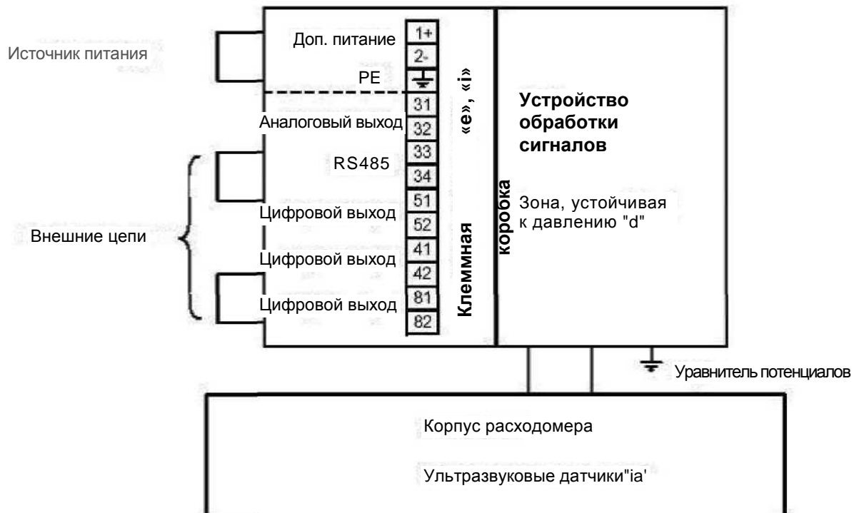
Рис. 3.9: Взрывозащита компонентов OPTISONIC 7060
