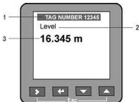
1. Строка заголовка – в нормальном режиме отображает номер позиции прибора
