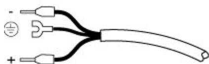
4. Подключите провода источника питания /токового выхода 1 к клеммам терминального блока 1 (d) в соответствии со схемой, расположенной ниже. Соблюдайте полярность соединений. Зажмите винты клемм.
