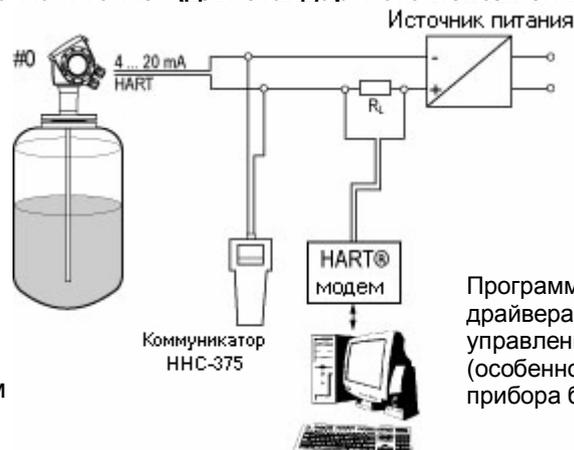
Программный пакет PACTware + DTM-драйвера (HART®) для удаленного управления и настройки прибора (особенно для версии исполнения прибора без дисплея).
