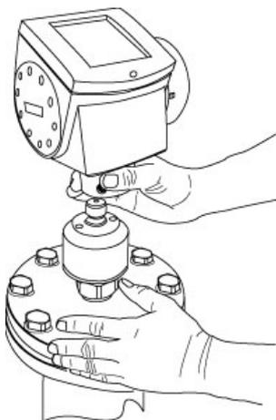
3. Снимите конвертор, двигая его вверх и вниз по вертикальной оси до полной выемки из штифта.
