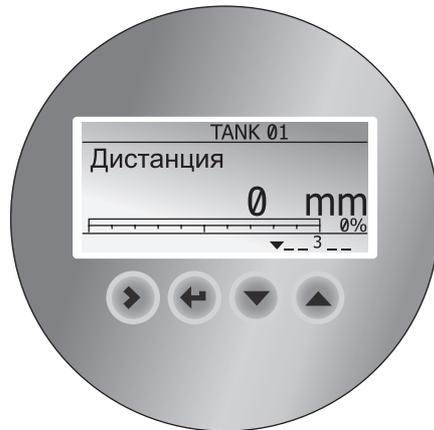
Дисплей может быть заказан вместе с устройством, либо отдельно, как аксессуар. Он отображает данные измерений на 128 x 64 пиксельном экране. С помощью меню настройки на дисплее можно быстро настроить прибор за несколько интуитивно понятных шагов. Доступны 9 языков.
