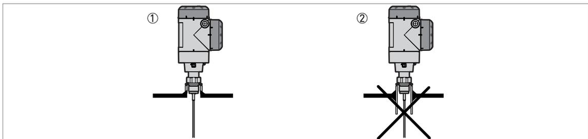
Рисунок 3-4: Бобышки для резьбовых технологических присоединений
