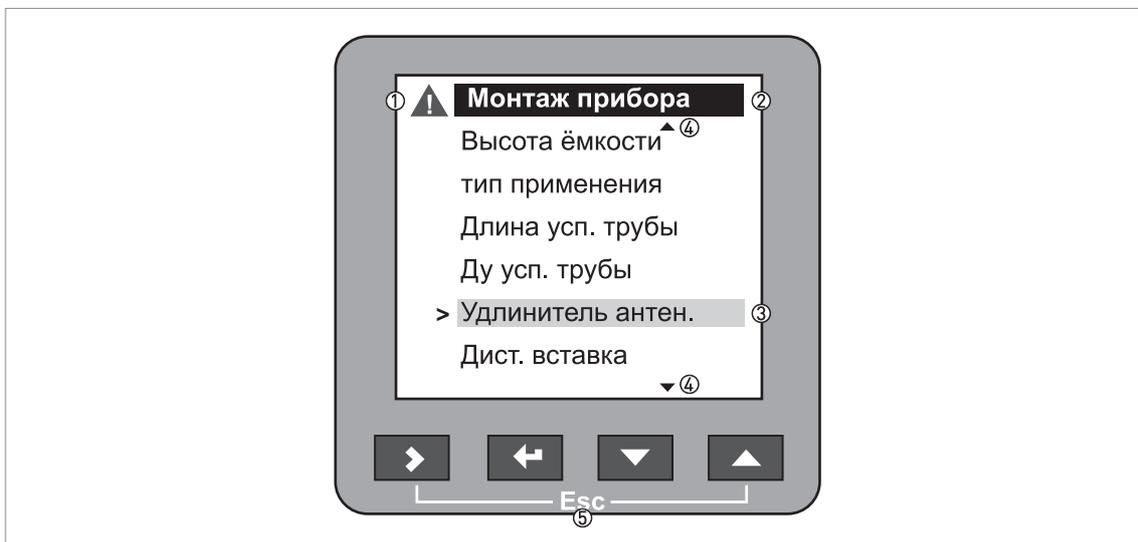
Рисунок 5-1: Расположение информации на экране локального дисплея
