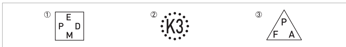
Рисунок 2-7: Символы на технологическом присоединении, указывающие на тип материала внутренней прокладки (на боковой стороне технологического соединения)
