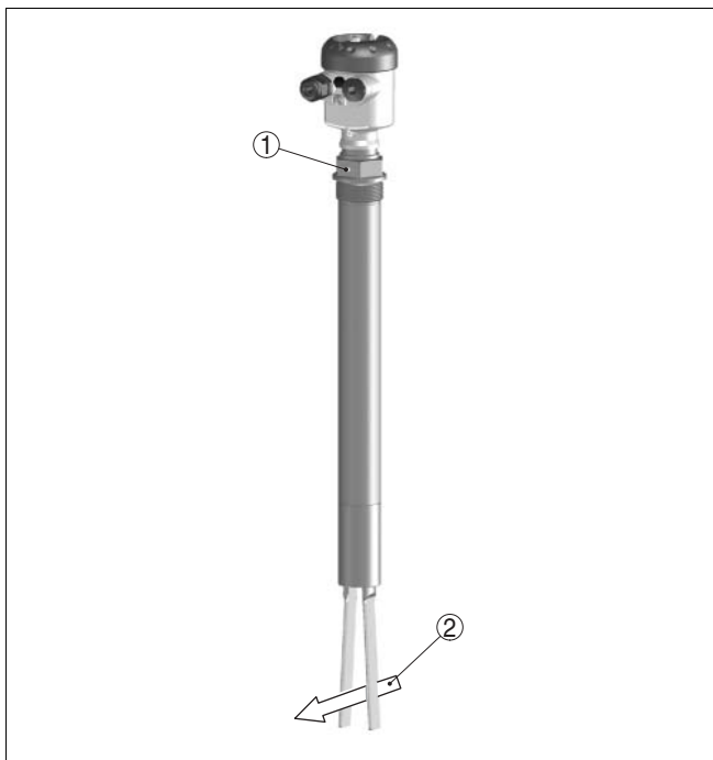
Рис. 6: Ориентация вибрирующей вилки относительно течения продукта
