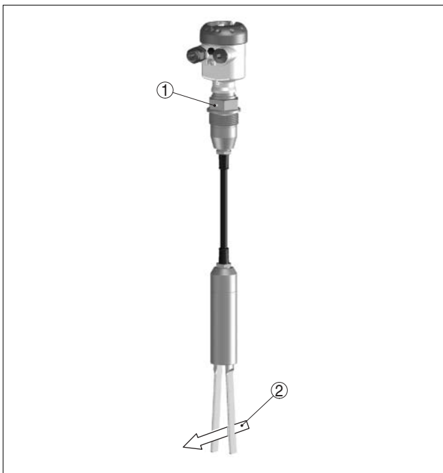
Рис. 6: Ориентация вибрирующей вилки относительно течения продукта
