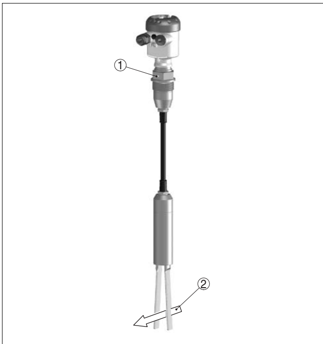
Рис. 6: Ориентация вибрирующей вилки относительно течения продукта 1 Маркировка на резьбовом присоединении 2 Направление течения
