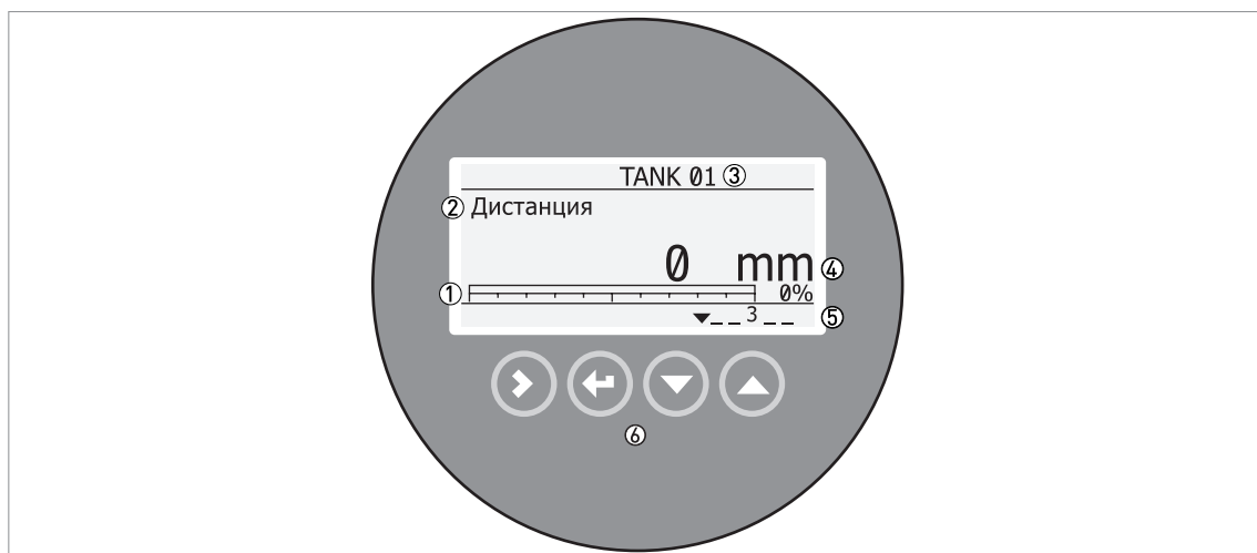
Рисунок 5-1: Расположение информации на экране локального дисплея в стандартном режиме (режиме измерения)
