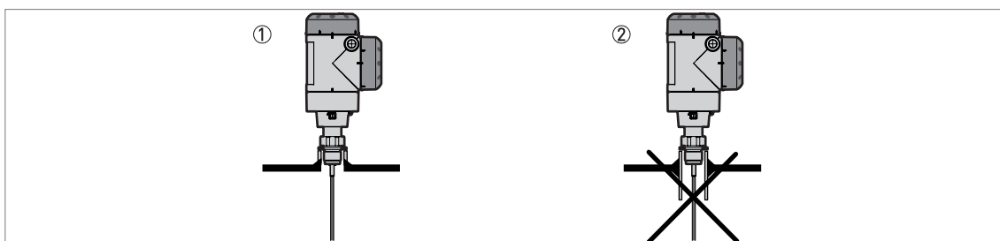
Рисунок 3-8: Бобышки для резьбовых технологических присоединений
