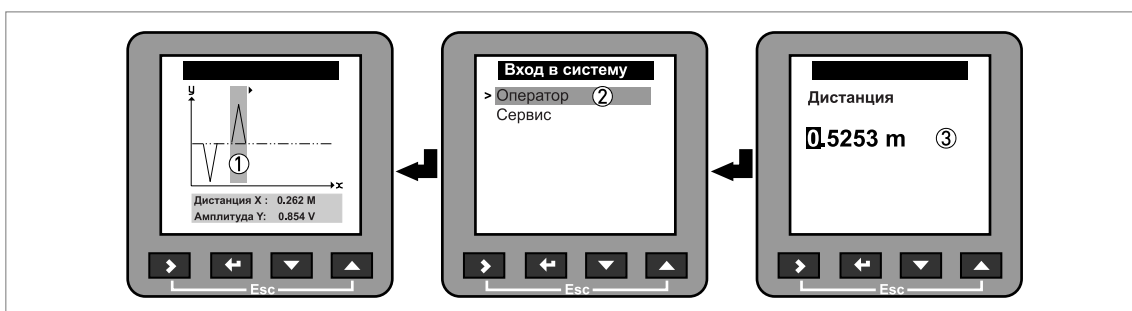
Рисунок 6-8: Настройка прибора для отслеживания достоверного сигнала уровня
