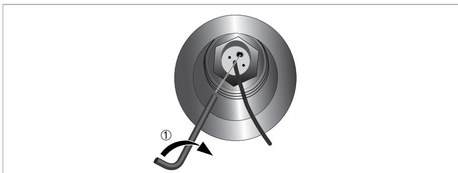
Рисунок 8-13: Затяните фиксирующий винт M2
