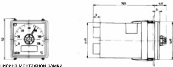
ширина монтажной рамки Вырез в панели щита 45^{+0,60} \times 45^{+0,60} мм Тип 8650-65-48
